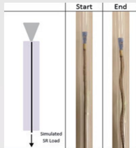
Column Strength가 낮은 경우, 스텐트 리트리버와 함께 사용 시 interaction에 영향을 줄 수 있으며, Column Strength가 높은 경우, Trackability에 영향을 주는 것을 테스트로 확인할 수 있었으며. EMBOVAC™ Aspiration Catheter의 경우 최적의 Column Strength를 가지고 있는 것을 확인할 수 있었습니다.
