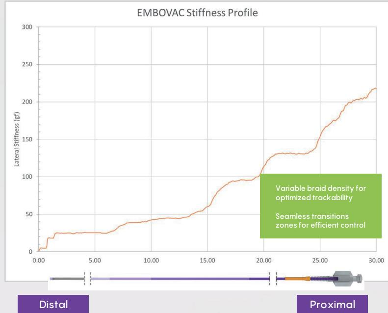
EMBOVAC™ Aspiration Catheter는 MCA까지 빠르게 네비게이션 될 수 있도록 디자인되었습니다. 각 구간별로 PPI(Picks Per Inch) 강도가 다르게 디자인되어 높은 PPI 구간은 Kink Resistance에 강하고 지지력이 좋은 반면, Distal tip의 부분의 낮은 PPI 구간은 유연하여 네비게이션에 용이하도록 제작되었습니다.
